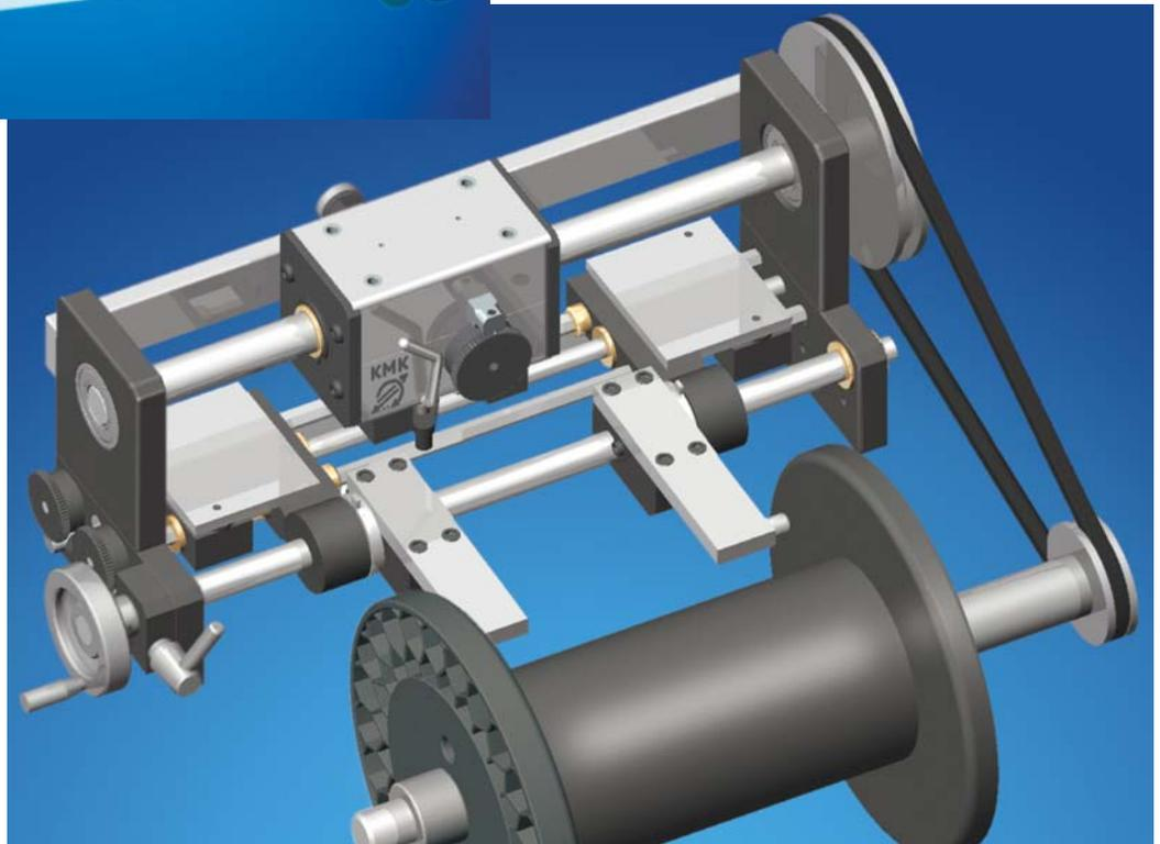
Mechanischer Sensor zur genauen, zeitsparenden Einstellung der Umschaltpunkte. Für Gradflanschspulen zum problemlosen Spulenwechsel ohne Nachjustierung
